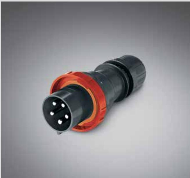
Las clavijas de la Serie OPTIMA-EX son aptas para su uso en entornos con clasificación Ex zona 21/Db - 22/Dc (debido a la presencia del polvo combustible del grupo IIIC).
