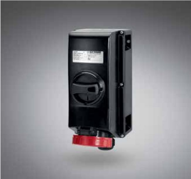
Las bases con dispositivo de bloqueo e interruptor antichispas (Ex db eb) de la serie ADVANCE-GRP[GD] son adecuadas para su instalación en entornos con clasificación Ex zona 1/Gb -2/Gc (debido a la presencia de gases, vapores y nieblas del grupo IIC) y/o zona 21/Db - 22/Dc (debido a la presencia de polvo combustible del grupo IIIC).
