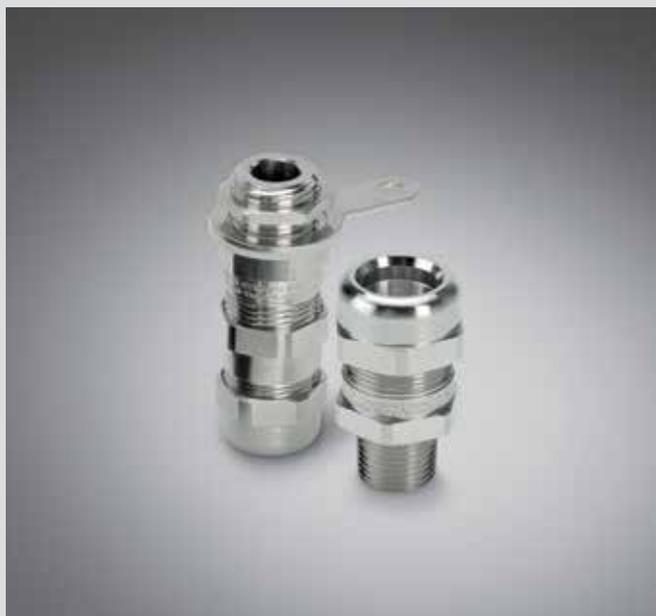
La serie UNION-EX en metal se compone de un prensacables y tapas metálicas de la marca RCN, en latón niquelado o en acero inoxidable AISI 316L para cables blindados o simples, con junta en PTFE, nailon o silicona, y todos los accesorios asociados.
