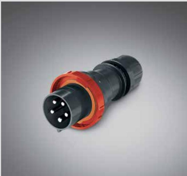
Las clavijas de la Serie OPTIMA-EX son aptas para su uso en entornos con clasificación Ex zona 22/Dc (debido a la presencia de polvo combustible en el grupo IIIC) en el esquema de autocertificación. Son compatibles con las tomas de corriente con bloqueo de la Serie ADVANCE-GRP, pero pueden conectarse, cuando se encuentran en una "zona segura", a cualquier toma de corriente conforme a la norma industrial IEC/EN 60309 que tenga la misma polaridad.
