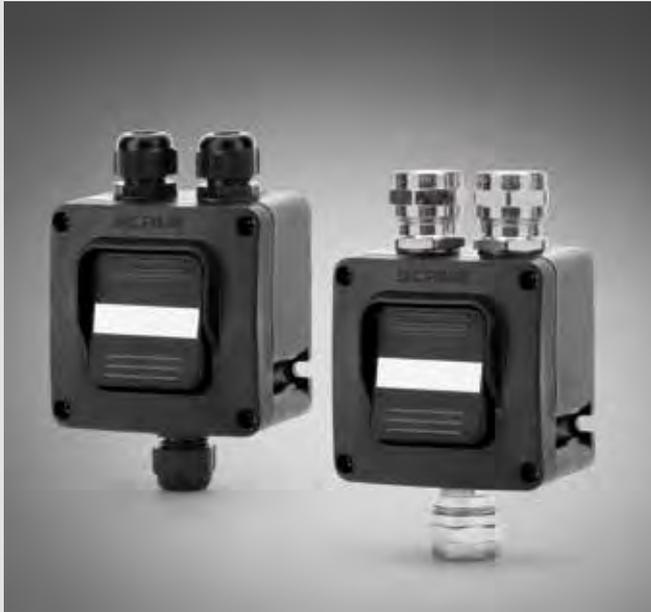
I dispositivi di comando della Serie ROCKER-EX[GD] per il controllo di impianti di illuminazione in ambienti con classificazione Ex zona 1/Gb -2/ Gc (per presenza di gas, vapori e nebbie del gruppo IIC) e/o zona 21/ Db - 22/Dc (per presenza di polveri combustibili del gruppo IIIC).
