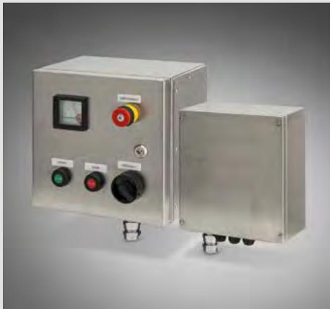
La serie ZENITH-S comprende custodie realizzate in acciaio AISI 304L o AISI 316L. Le custodie possono essere fornite con coperchio con fissaggio a vite, con cerniere e/o flange sui quattro lati. Sono adatte all'installazione in ambienti con classificazione Ex zona 1/ Gb -2/Gc (per presenza di gas, vapori e nebbie del gruppo IIC) e/o zona 21/Db - 22/Dc (per presenza di polveri combustibili del gruppo IIIC).
