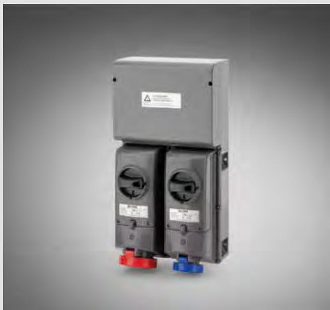
Le prese interbloccate con blocco meccanico della Serie ADVANCE-GRP[EX] sono idonee alla composizione di batterie di distribuzione per l'installazione in ambienti con classificazione Ex zona 22/Dc (per presenza di polveri combustibili del gruppo IIIC) in regime di autocertificazione. Equipaggiabili con contatti ausiliari, acquistabili a parte, senza perdere la certificazione.
