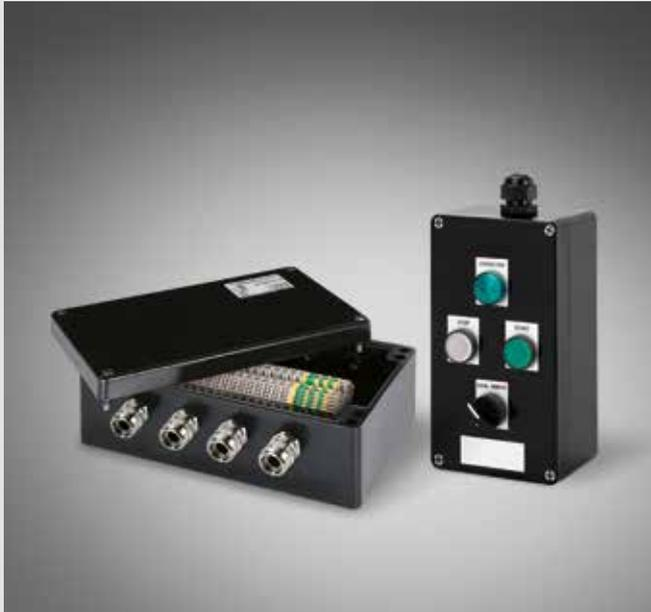
La gamme ZENITH-P comprend des enveloppes en polyester renforcé de fibre de verre (GRP) de différentes tailles qui ont une excellente résistance aux efforts mécaniques, aux contaminations, à la corrosion et qui peuvent être utilisées pour les applications LSZH (Low Smoke Zero Halogen). De plus l'ajout de carbone élimine le risque d'inflammation due à l'électricité statique.
