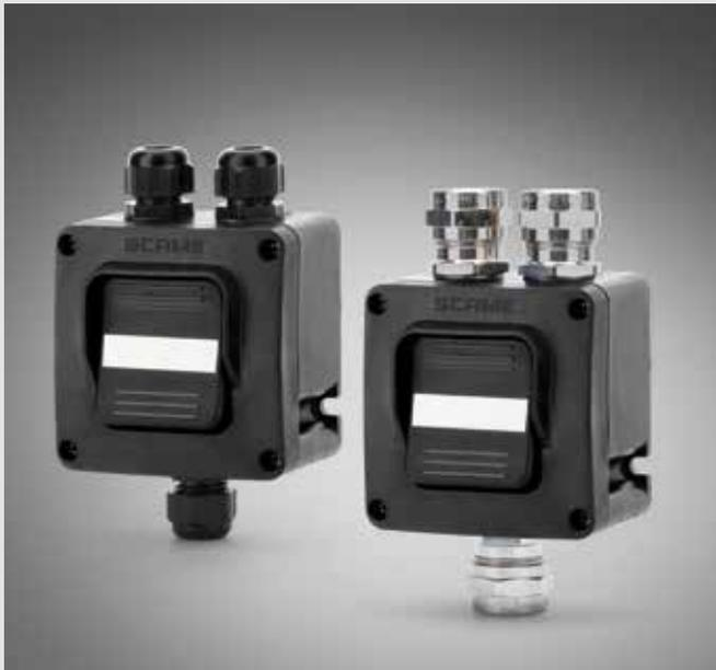
Les interrupteurs de la gamme ROCKER- EX[GD] sont destinés à contrôler les systèmes d'éclairage dans les environnements avec classification EX zone 1/Gb 2/Gc (du fait de la présence de gaz, vapeurs ou fines gouttelettes du groupe IIC) et/ou zone 21/Db 22/Dc (du fait de la présence de poussière combustible du groupe IIIC). Ils existent en version marche-arrêt, va-et-vient, et bouton-poussoir bipolaire.
