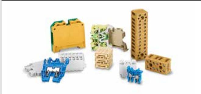
Les bornes sont montées sur rail ou platine de montage. Rail DIN (TS15, TS 35) : 1 rangée. Bornes certifiées avec section de 1,5mm<sup>2</sup> jusqu'à 240mm<sup>2</sup>.
