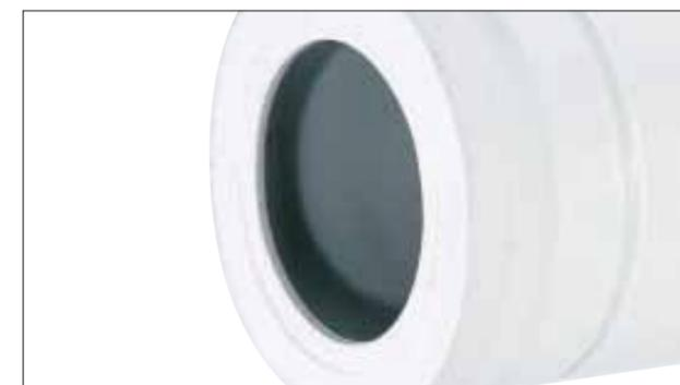
L'utilizzo di un sistema di co-stampaggio consente alla guarnizione in tecnopolimero di risultare un prolungamento del corpo del prodotto e di mimetizzarsi con il tubo, oltre a fornire una maggiore tenuta del grado di protezione e un più facile inserimento dei raccordi, senza schiacciare e deformare la guarnizione.
